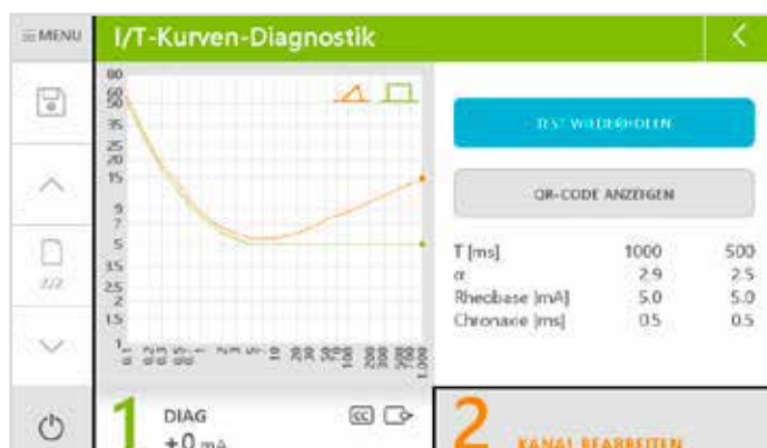
Neben der Standard-I/T-Kurve bietet das Diagnostikmenü auch einen Zeit sparenden Schnelltest
